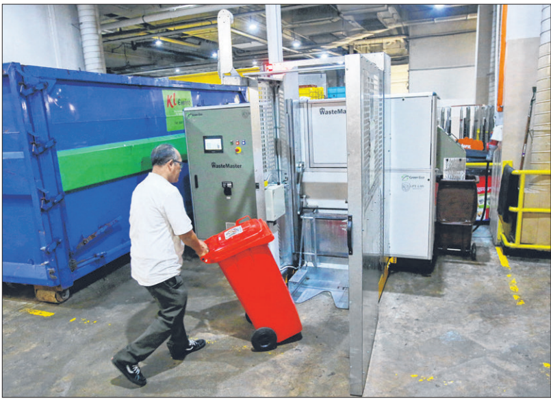
厨余处理系统WasteMaster每天可处理高达1000公斤的厨余，还能将食物垃圾的重量减少80%，转化成安全且营养价值高的基质。这些基质在培养成蛋白质后，可制作成水产养殖的饲料。（特约陈福源摄）
